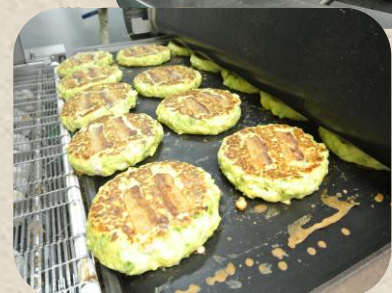
電気式テフロンコンベヤー焼成機でお好み焼きを焼き上げる工程
